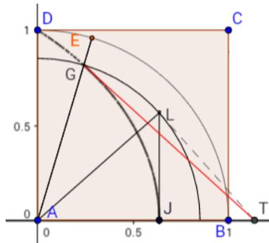
Abbildung 13: Konstruktion der Tangente von Punkt  $G$  (rot eingezeichnet).
