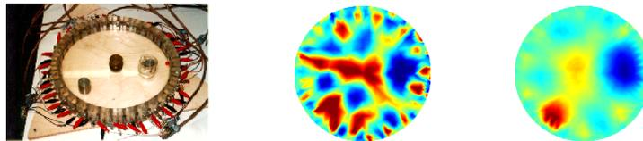
Versuchsaufbau für reale Daten (links), eine Rekonstruktion mit "Overfitting" (Mitte) und eine regularisierte Rekonstruktion (rechts)
