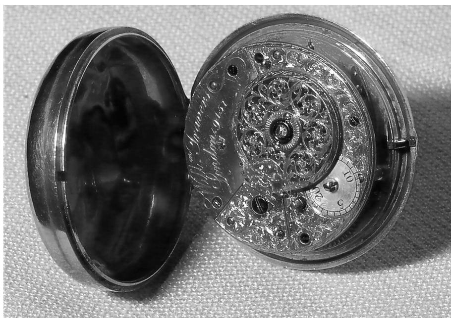
Abb. 2: Taschenuhr von William Travers. Werkseits mit graviertem Kloben und Diamantdeckstein
