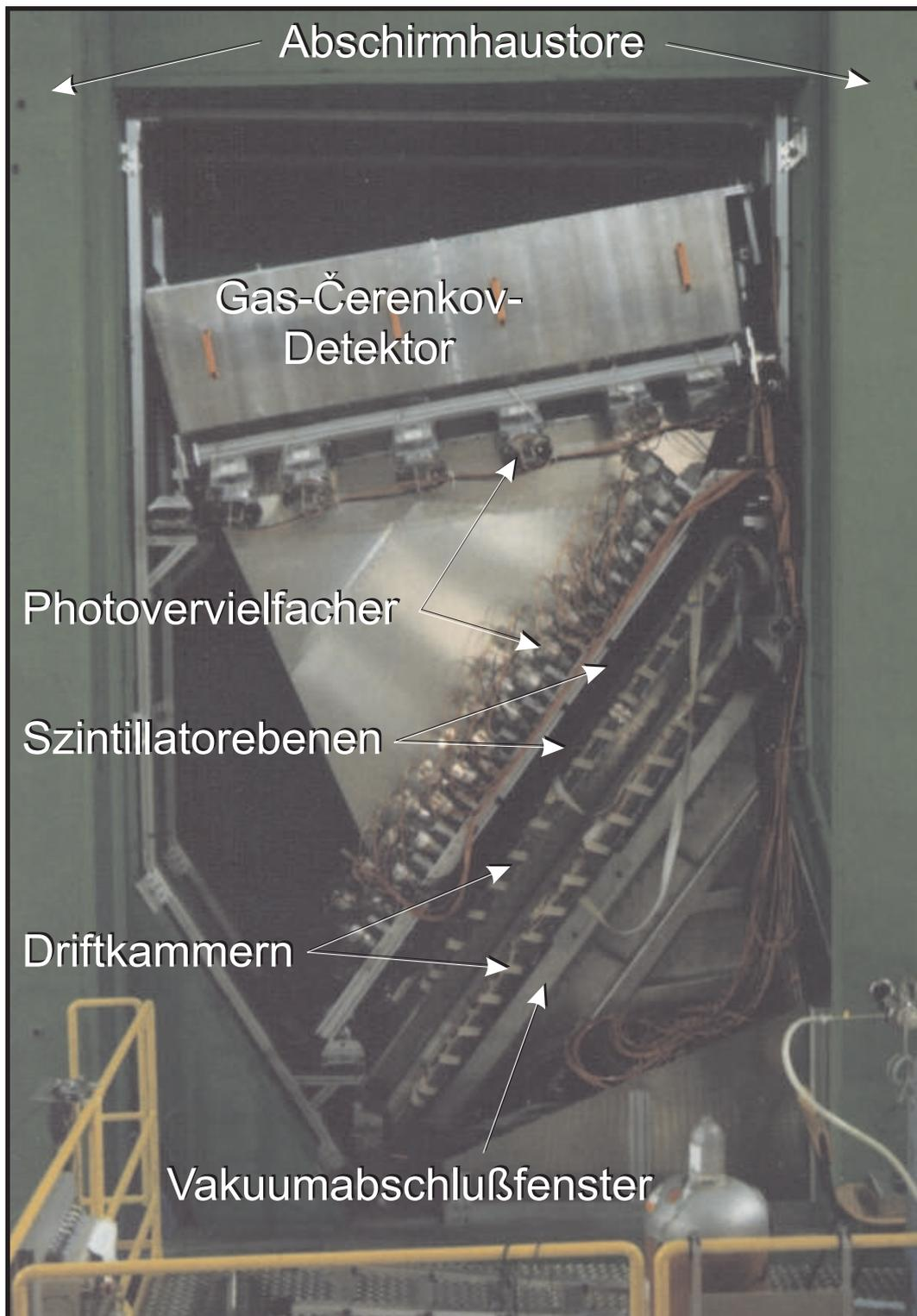
Abb. 3.3: Die Spektrometerdetektoren.
