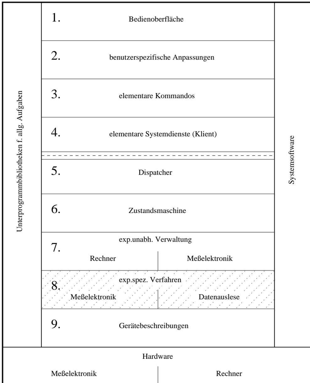
Abb. 5.1: Schichtenmodell der zentralen Datenerfassungs-Software von MECDAS. Der schraffierte Bereich kennzeichnet den Teil der Software, der experiment- bzw. detektor-spezifische Komponenten enthält
