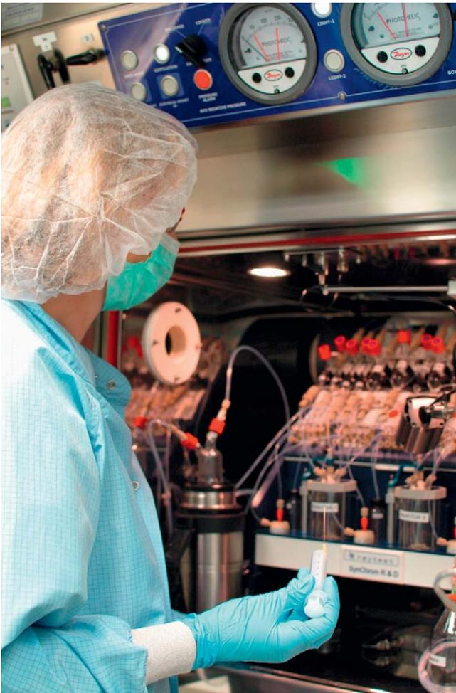
Abb. 5 geöffnete Heizelle BBS2-V mit Synthesemodul SynChrom.
