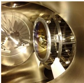
Die an der Johannes Gutenberg-Universität Mainz hergestellte Uran-233-Quelle (große Scheibe in der Bildmitte) wurde in die Experimentiereinrichtung an der LMU München eingebaut. In der perfekt glatten Oberfläche spiegeln sich Komponenten der Apparatur.
