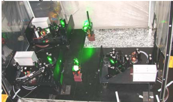
Abbildung 1: Anordnung der drei Ti:Saphir-Laser in einer Flowbox. Der Pumplaser steht außerhalb des rechten Bildrandes.
