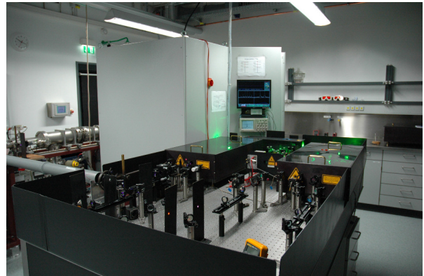
Abb. 3: Das neue Laserlabor im Neubau Kernchemie, sichtbar sind der neue Lasertisch, der neue Elektronikschrank und das (alte) TOF-MS
