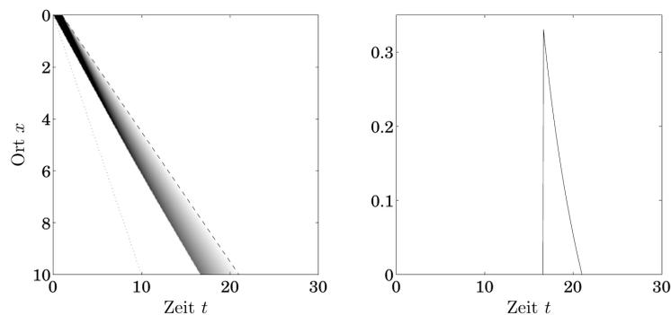
Konzentrationsverteilung innerhalb einer Chromatographie-Säule (links) und Ausfluss aus der Säule als Funktion der Zeit (rechts)
