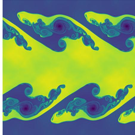
Gemeinsam statt einsam: Diese detaillierte Flüssigkeitssimulation einer *Kelvin-Helmholtz-Instabilität* berechnen wir in endlicher Zeit nur durch effektives parallelisieren auf 265 Rechenknoten von *Mogon*.
